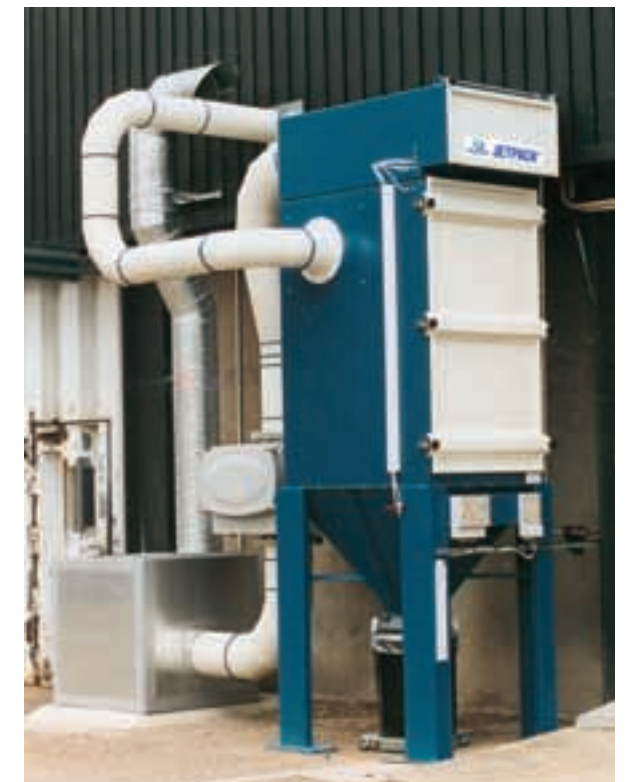
Dépoussiérage d'un atelier de découpe de joints d'amiante. Filtration on cutting of asbestos joints.
